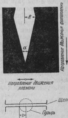
Рис. 63. Фотография распространения пламени в мыльном пузыре.
