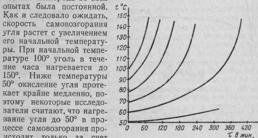
Рис. 34. Изменения скорости самовозгорания угля от изменения начальной температуры.
